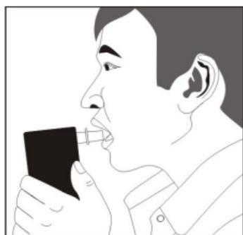
Необходимо производить продувание в мундштук непрерывно с умеренной силой в течение около 6 секунд, до окончания звукового сигнала и характерного щелчка.
