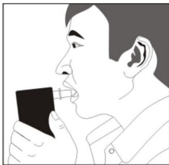
После непродолжительного анализа (на дисплее высвечивается надпись WAIT и «бегущая» цифра 0) появится цифровой результат. Через 20 секунд прибор выключится автоматически.
